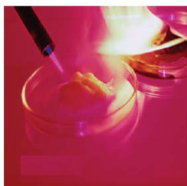
روانکار هیدروکربنی می سوزد اما روانکار پرفلئورواتر نمی سوزد.
