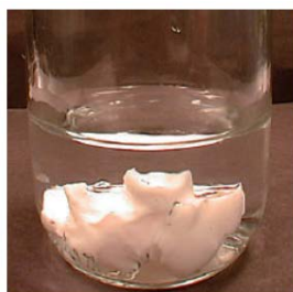
گریس پرفلئورواتر در هیدروکربن حل نمی شود
