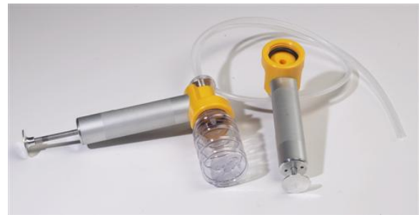
شکل یک : تجهیز رایج برای نمونه گیری روانکارهای مایع
