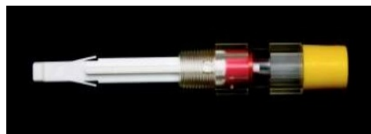
شکل پنج: تجهیزات تجاری جدید برای نمونه گیری مناسب از گریس
